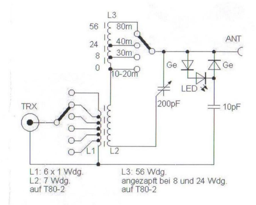
Windung. Die Schwingkreisspule hat 7 Windungen 0,5mmCuL. Die Einkoppelspule ist zwischen die ersten Windungen der Schwingkreisspule gewickelt. Die Einkoppelspule ist umschaltbar ausgeführt, wobei nicht benutzte Windungen offen bleiben.
