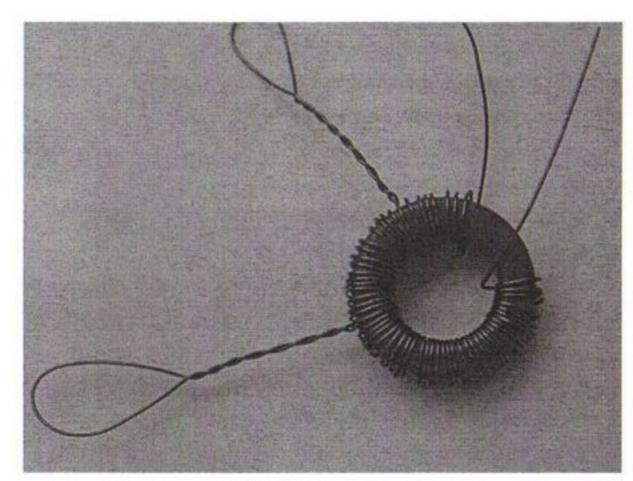
Wickel 8 Windungen, forme eine Schlaufe, wie bereits bei L1/L2 geübt, wickel weiter bis zur Windung 24 und forme eine weitere Schlaufe, und wickel dann die restliche Windungen bis Nr. 56. Alle Windungen werden dicht an dicht (innen) gewickelt. Nun wieder anpassen und ablängen: Der Anfang geht an PIN
